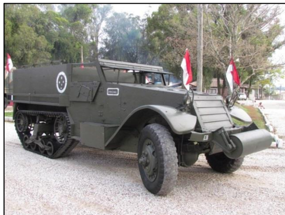
Figura 18 – Viatura blindada de transporte de pessoal de meia-lagarta M3, do acervo histórico do 3º Regimento de Cavalaria Mecanizado. Bagé, RS.
