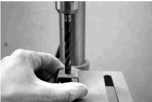
Drilling the die holes.
