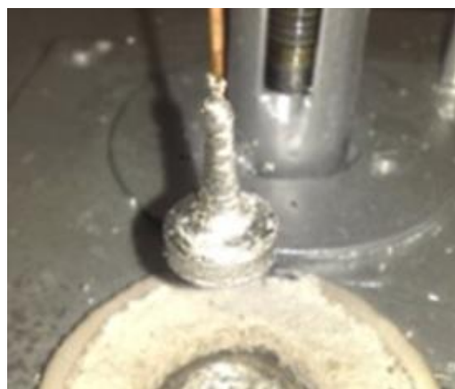
Рис. 2.23. Выращенный монокристалл олова методом Чохральского.
