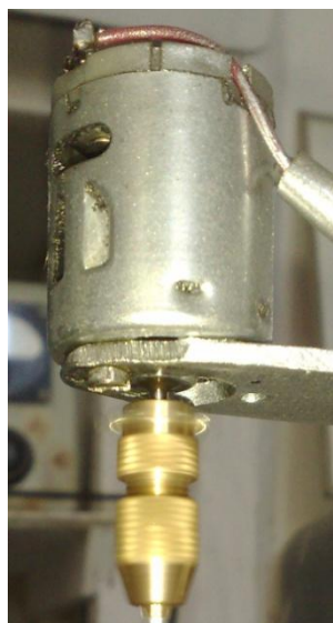
Рис. 2.9. Электродвигатель и держатель затравочного кристалла.
