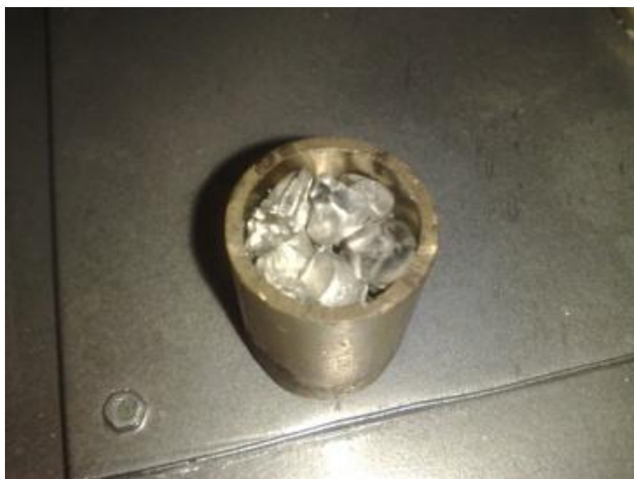
Рис. 2.14. Шихта загруженная в тигель.
