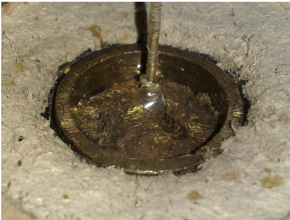
Рис. 3.2. Момент роста кристалла при помощи медного затравочного кристалла.
