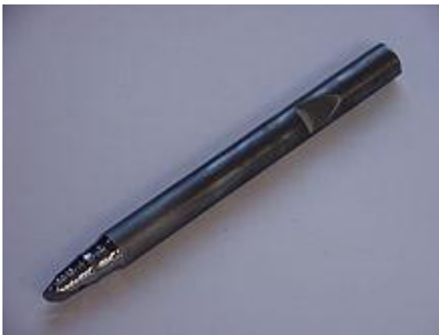
Рис. 1.3. Круглый затравочный кристалл олова с фрагментом начала оттяжки.
