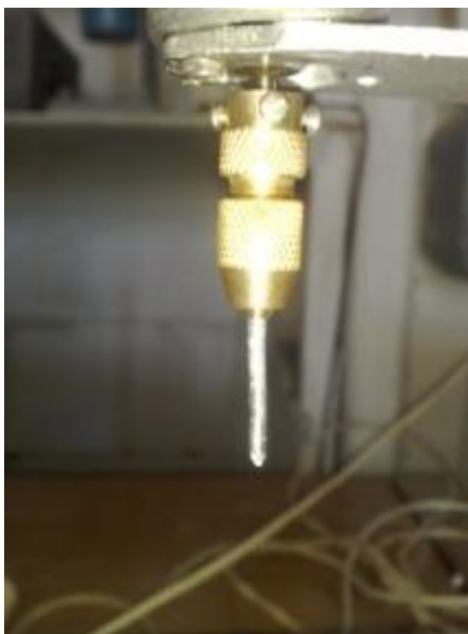
Рис. 2.17. Затравочный кристалл закрепленный в кристаллодержатель.
