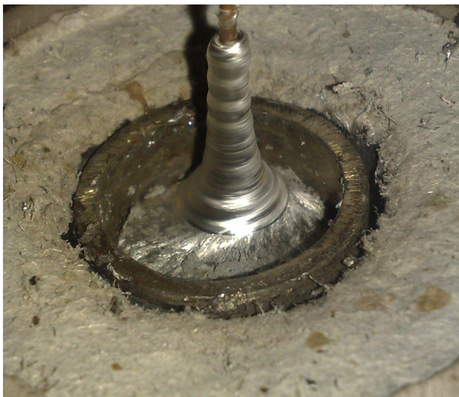
Рис. 3.4. Рост монокристалла олова при помощи медного затравочного кристалла после введения канифоли.
