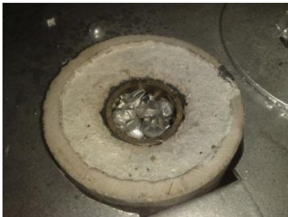
Рис. 2.15. Тигель загруженный шихтой и помещенный в печь.
