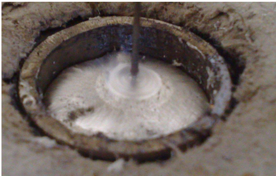
Рис. 3.3. Образование переходного слоя при выращивании монокристалла олова при помощи медного затравочного кристалла после введения канифоли.
