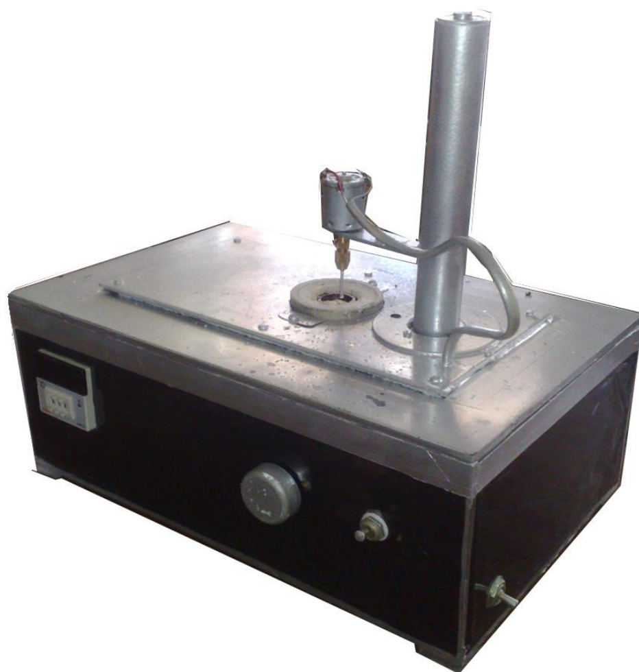
Рис. 2.13. Лабораторно – экспериментальная установка для выращивания монокристаллов олове методом Чохральского.
