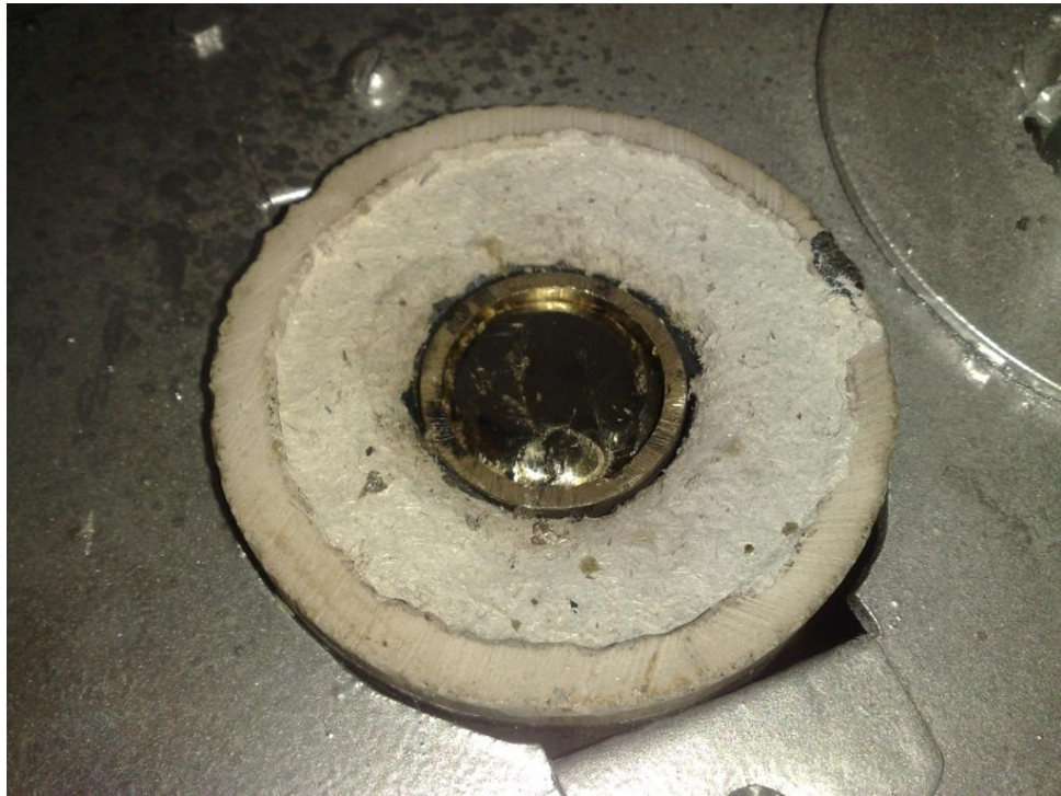
Рис. 3.1. Поверхность расплава покрытая оксидной пленкой.
